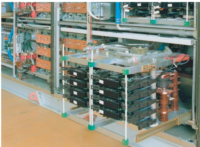
Фазные модули инвертора привода ACS5000 с водяным охлаждением, монтируются на выдвижных направляющих.
